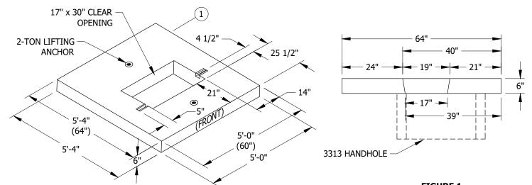
FIGURE 1 PAD FOR EATON-COOPER SERVICE RESTORER ISOMETRIC VIEW
