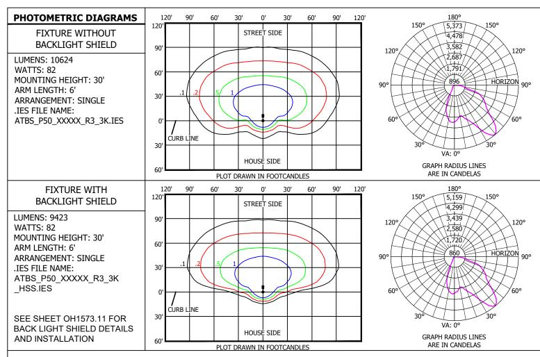
**ATTENTION:** LUMEN OUTPUT FAO SWITCH POSITION MUST BE INCLUDED FOR EACH FIXTURE WITHIN THE CONSTRUCTION NOTES FOR EACH LOCATION IN THE JOB PACKAGE.
