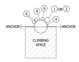
FIGURE 2 DEADEND CONSTRUCTION SINGLE POWER RISER
