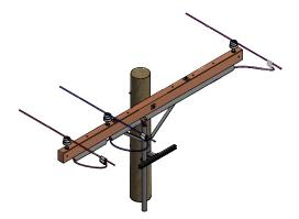
**FIGURE3** CROSSARM CONSTRUCTION #2 CABLE MAX. ISOMETRIC VIEW
