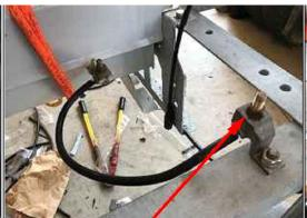
GROUND SWITCH FOR SWITCH FRAME
